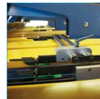
Battuta di riscontro programmabile con dita ribaltabili
