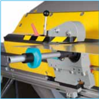
Längsschneideautomat mit Schnittspaltverstellung und variabler Blechauflage
