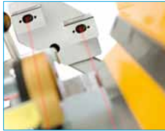
Laserüberwachung des Klemmbereichs zur optimalen Unfallverhütung
