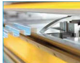
Individuell an Kundenbedürfnisse angepasste Greiffinger zum Wechseln – Anschlagfinger für sehr geringe Auflagefläche des Blechs (von 5 - 24 mm)
