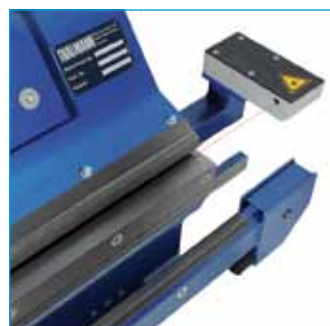
Laserüberwachung des Klemmbereichs zur optimalen Unfallverhütung
