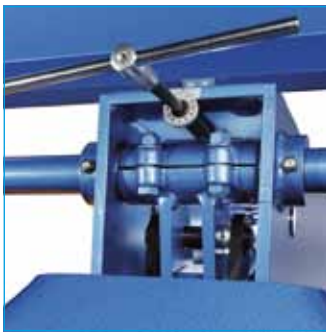
Unkompliziertes Einstellen mittels Oberwangen-Feinregulierung
