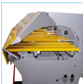
Auf Coillbreite abgestimmte Einlegetiefe von 1250 mm
