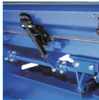
Detail der gesteuerten Biegewange mit gehärteten Schwingenlagern
