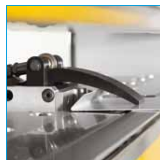
40 mm Greiferöffnung zum Handhaben von aufgebogenen Blechen
