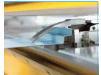
Individuell an Kundenbedürfnisse angepasste Greiffinger zum Wechseln – Anschlagfinger für sehr geringe Auflagefläche des Blechs (von 5 - 24 mm)
