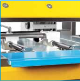
Beinahe grenzenloses Biegen mit variablem Kurzlängenanschlag
