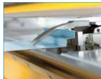
Diti pensili fatti su misura intercambiabili – Diti ribaltabili per lavorare le misure minime (di 5 – 24 mm)
