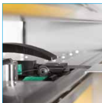
Maneggio del materiale tramite dita o pinze della battuta
