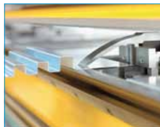
Diti pensili fatti su misura intercambiabili – Diti ribaltabili per lavorare le misure minime (di 5 – 24 mm)
