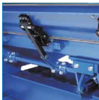
Dettaglio dell'albero di trasmissione, snodo di biella e braccio oscillante con cuscinetto
