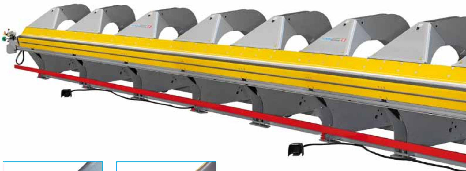
Il sistema di allineamento incorporato consente di regolare ogni singolo braccio della piegatrice
