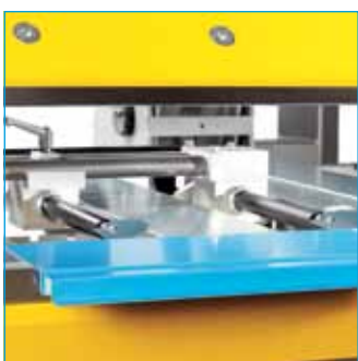
Flessibilità: Battuta regolabile per la lavorazione di parti corte
