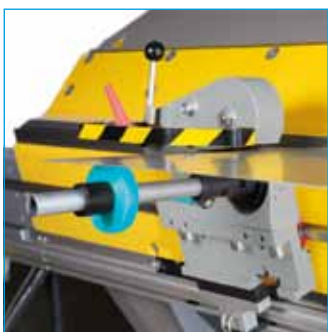
Taglierina con lame regolabili per vari spessori di lamiera e supporto di taglio
