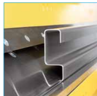
Pieghe perfette anche con lamiera d'acciaio da 3 mm (400 N/mm 2 )
