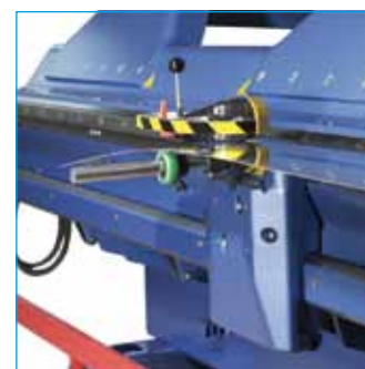
Taglierina top moderna con lame regolabili per la lavorazione di vari spessori di lamiera
