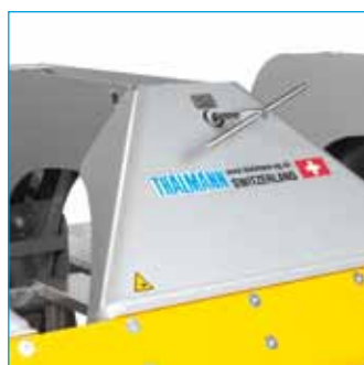
Il sistema di allineamento incorporato consente di regolare ogni singolo braccio della piegatrice
