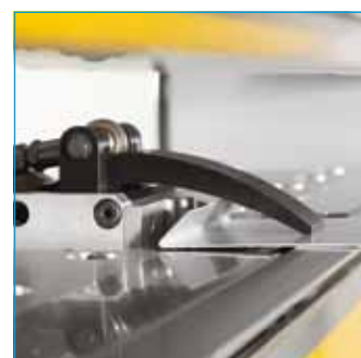
Maneggio del materiale tramite dita o pinze della battuta
